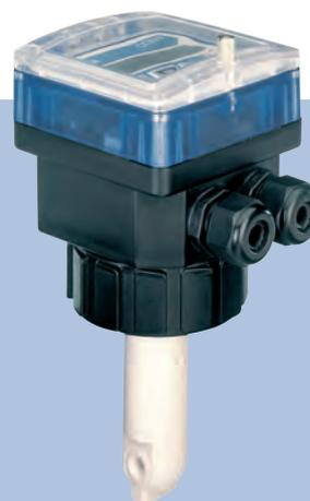
Transmisor de conductividad inductivo/toroidal con salidas programables. La salida analógica de 4–20 mA es proporcional a la conductividad. La unidad puede equiparse con dos relés de 3A. La unidad tiene un rango de medición muy amplio. La versión estándar es de PVDF; la versión PEEK está disponible para soluciones CIP.
