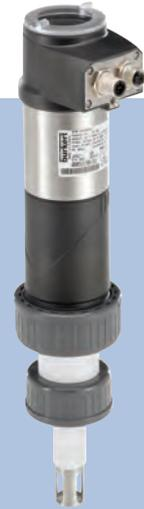
Transmisor de pH/rédox con salidas programables. Salida de pH/rédox y temperatura a través de salidas simples o duales analógicas 4–20 mA. También se incluyen dos salidas de transistor.
