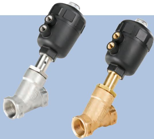
Válvula de asiento inclinado clásica de Bürkert. Diseñada para lograr una extraordinaria vida útil, es perfecta para sustituir a las válvulas de bola. Configuradas con flujo por debajo del asiento para líquidos, estas válvulas sin golpe de ariete utilizan empaquetadura autoajustable y un actuador de pistón con junta en N, todo ello en una probada envolvente compacta de gran resistencia.
