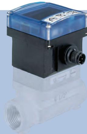
Caudalímetro compuesto de un transmisor SE32 y un fitting para caudal S030 acoplados por bayoneta. La pantalla digital con teclado de 3 botones y gráfico de barras es perfecta para líquidos neutros exentos de sólidos. La histéresis y tiempo de retardo ajustable lo convierten en un inteligente componente en todo bucle de control de caudal.
