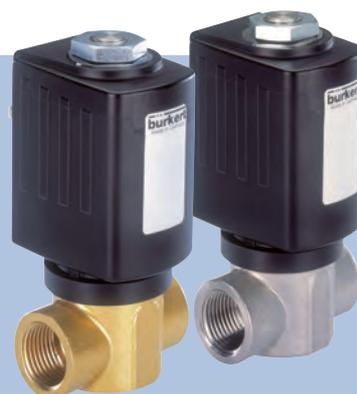
El tipo 6027 es una electroválvula de accionamiento directo utilizada para cerrar, dosificar, llenar y ventilar. El sistema de bobina insertable tiene un diseño modular y la bobina puede rotar 360°.
