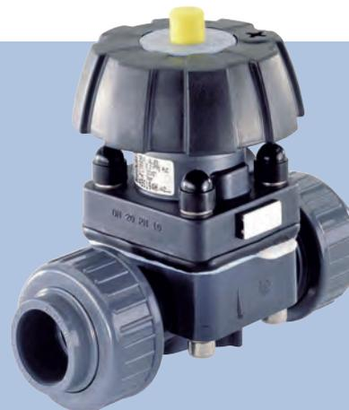
Válvula de diafragma manual para sustancias químicas agresivas. Ofrece una larga vida útil incluso con líquidos contaminados, sucios o muy viscosos. La membrana entre el actuador y el cuerpo aísla herméticamente el fluido del actuador y proporciona un robusto cierre sobre el asiento de la válvula. Su naturaleza manual significa que la válvula puede usarse para cerrar y también para controlar el flujo.
