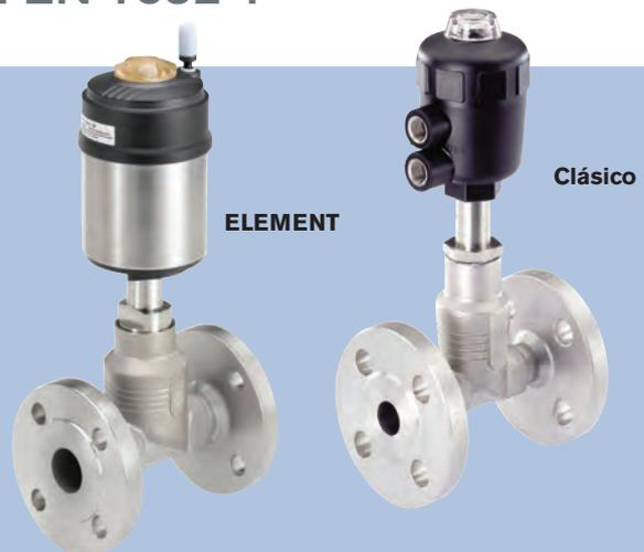
Válvula de globo con bridas en acero inoxidable, diseñada para reemplazar a las válvulas de bola con bridas en los casos en que el mantenimiento o la vida útil son cuestiones importantes. Estas válvulas, que en esta página se muestran en configuración normalmente cerrada con flujo por debajo del asiento para líquidos, presentan empaquetadura autoajustable y actuador de pistón con junta en N, todo ello en una envolvente compacta y robusta que cumple todos los estándares de Norte América.
