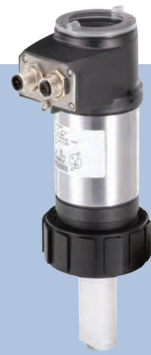
El caudalímetro de tipo inserción compuesto de un transmisor SE26 ofrece una salida 4 a 20 mA ( dos hilos) directamente proporcional al caudal. Una gama de fittings desde casquillos soldar a collarines, hace que estos transmisores ELEMENT sean perfectos para líquidos neutros exentos de sólidos. Una pantalla retroiluminada extraíble con programación mediante joystick permite que los trabajos de mantenimiento sean rápidos.
