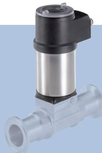
Caudalímetro compuesto de un sensor SE36 y cualquiera de los fittings S030 que aparecen en la página 65 conectados por bayoneta. Este caudalímetro INLINE de dos hilos 4 – 20 mA se fabrica con el objeto de proporcionar una lectura de caudal real y fiable para líquidos neutros exentos de sólidos. Una pantalla retroiluminada extraíble proporciona valor añadido al sistema ya que puede programar múltiples transmisores.
