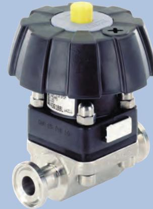
Válvula de diafragma manual diseñada específicamente para las aplicaciones biosanitarias según 3A/FDA. El cuerpo de acero inoxidable 316L de forja puede entregarse con un pulido específico y con una variedad de materiales de diafragma que se adaptan perfectamente en aplicaciones con fluidos ultra puros, abrasivos y agresivos. La válvula de diafragma es la solución más idónea para estas aplicaciones debido a su diseño, su drenabilidad y su diseño sin zonas muertas.
