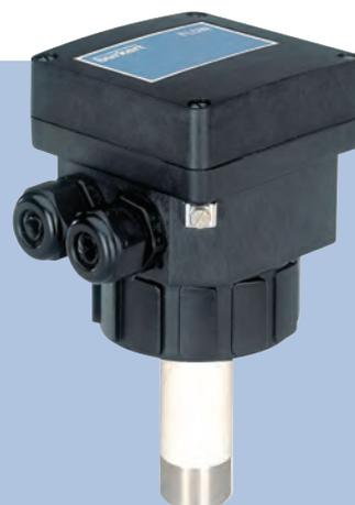
Caudalímetro electromagnético de inserción compuesto de una sonda de PVDF y un módulo electrónico ciego de alta calidad. Perfecto para líquidos contaminados o agresivos, cuenta con salida de impulsos y 4 a 20 mA, con relés de 3A opcionales, lo que lo convierte en una solución flexible de control de caudal o dosificación.
