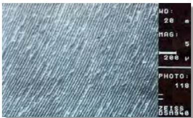
La superficie de un asiento de PTFE mecanizado y aumentado 50 veces
