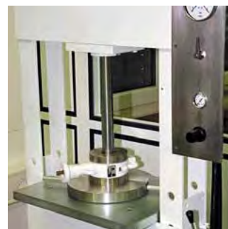
Ensayo de espesor
