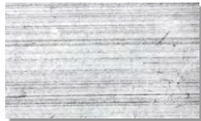
La superficie de un asiento de ULTRAFLO ® sin mecanizado aumentada 25 veces
