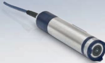
OPTISENS ADO 2000 Sensor amperométrico para medir el oxígeno disuelto, provisto de cartucho con electrodo fácilmente recambiable
